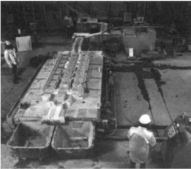
Fig. 11 Hot-top level pour system. Source: Ref 1
